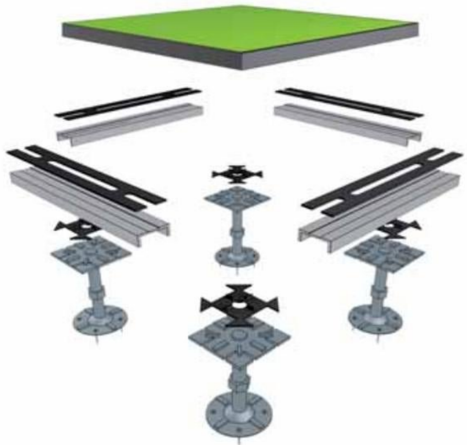
ESQUEMA 2.1. Partes de un pavimento técnico.
