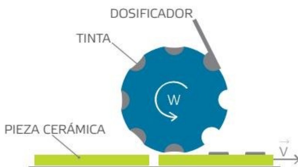
ESQUEMA 1.8. Esquema funcionamiento huecograbado.
