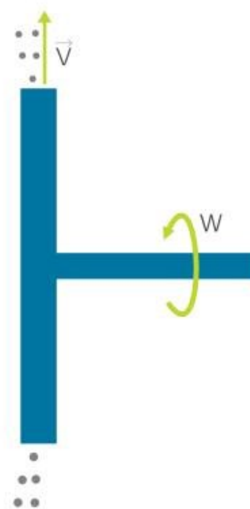
ESQUEMA 1.4. Funcionamiento de un disco giratorio para aplicar suspensiones de esmalte o engobe.
