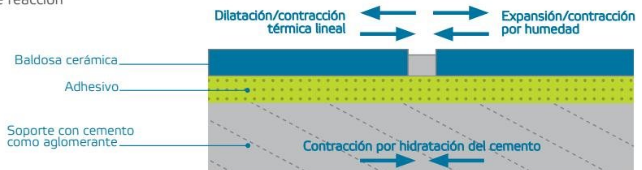
ESQUEMA 3.3. Deformabilidad de un adhesivo.
