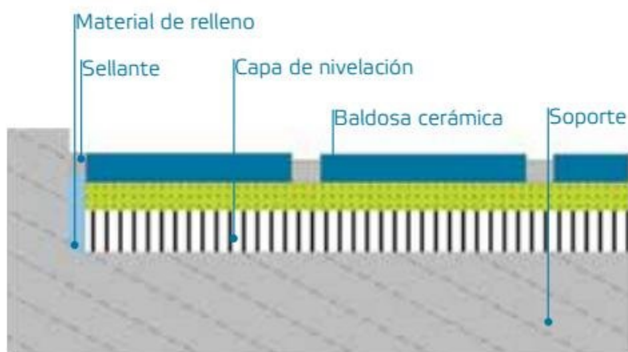
ESQUEMA 3.6. Junta perimetral.
