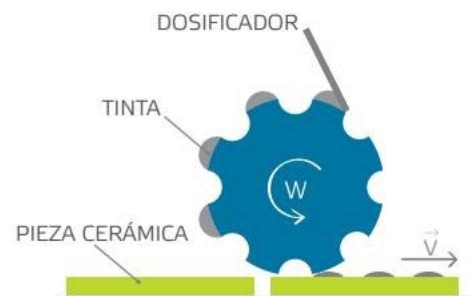
ESQUEMA 1.9. Esquema funcionamiento flexografía.
