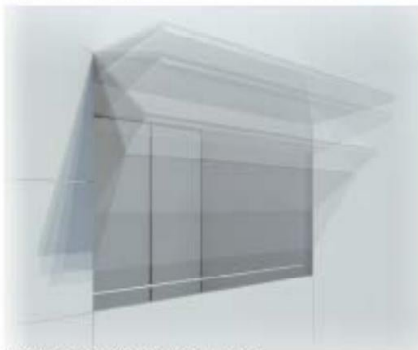
Sistema de control solar en fase de apertura.
