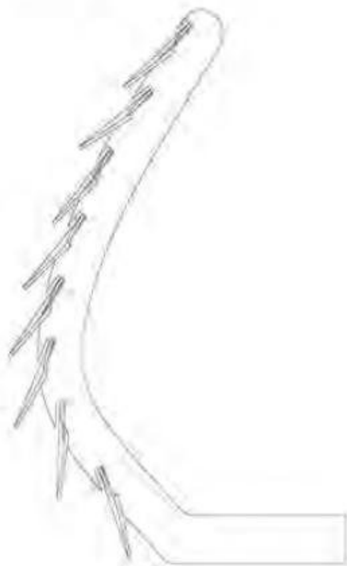
Vista de perfil de la barrera sónica
