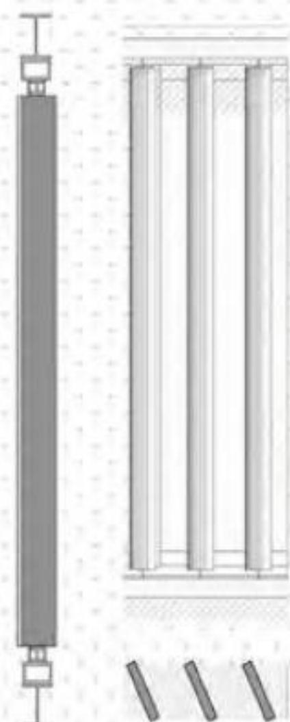
Planta, alzado y perfil de lamas fijas.
