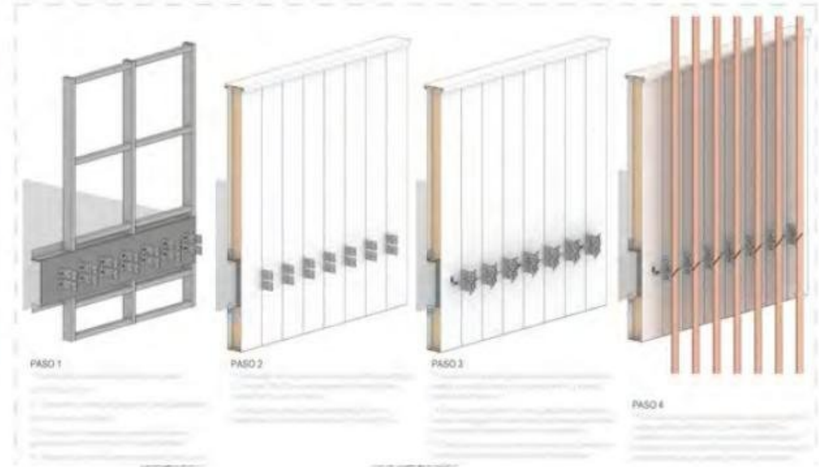
MONTAJE DE SISTEMA CERÁMICA DE FACHADA DE LAMAS Y ENVOLVENTE TÉRMICA
