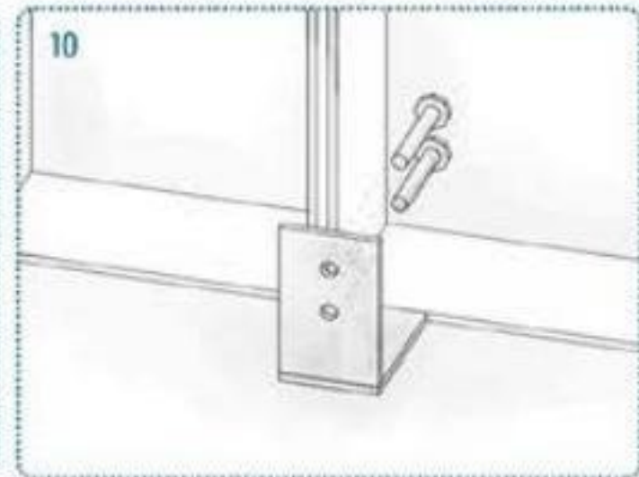
10. Para asegurar la estabilidad del conjunto, se atornillará la estructura mediante pletinas a los forjados del edificio. Es un enganche por seguridad aunque se podría considerar un sistema autoportante.
